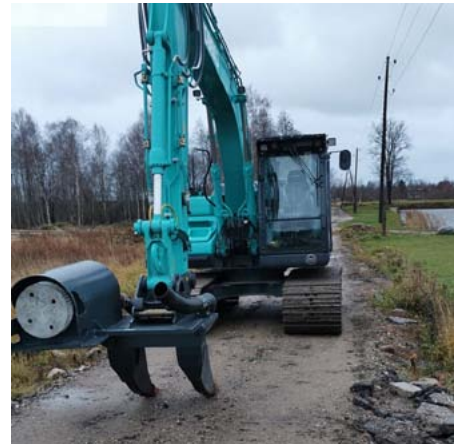
Makšķernieku kluba Salackrasti iegādātais ar grunts irdinātāju un hidraulisko ūdens sūkni aprīkots ķēžu ekskavators Salacas tīrīšanai
