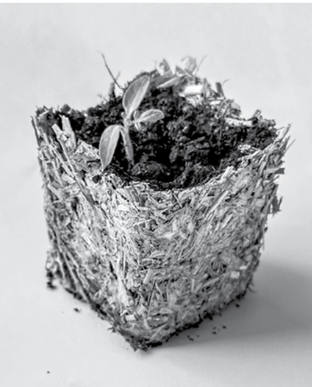
Stādu podiņa prototips, kas veidots no vietējiem resursiem, salīmējot tos ar karaginānu
