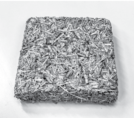
Konsolidācijas granta ietvaros izstrādātais siltumizolācijas materiāla prototips. Materiālam izmantoti meldri, niedres no Liepājas ezera, tos sajauc ar karaginānu, kas iegūts no Liepājas pludmalē izskalotajām sārtalģēm
