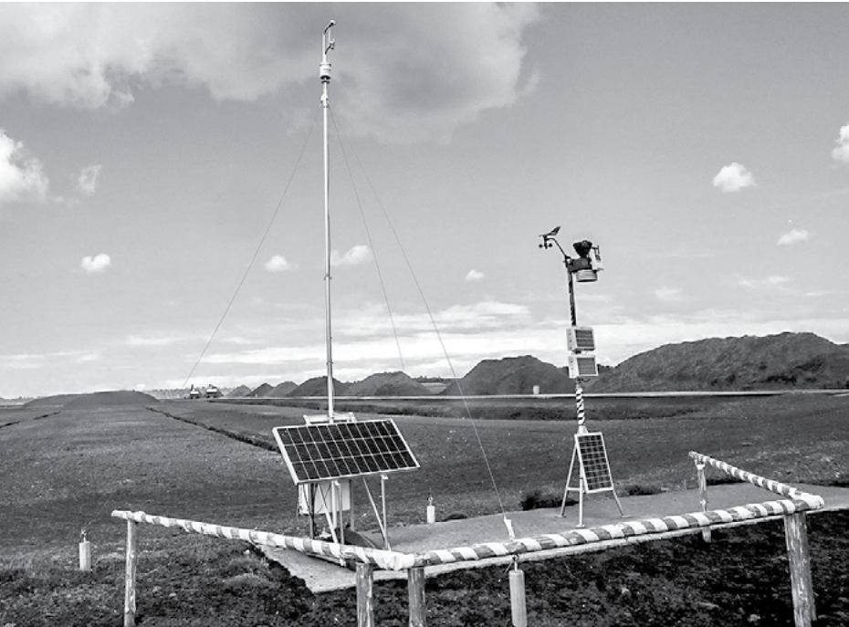
Drabiņu purvā uzstādītā iekārta, kas mēra SEG emisijas, fiksē daudzus un dažādus datus, tostarp vēja virzienu, stiprumu, nokrišņus
